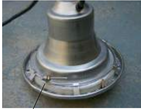
Abrazadera de sujeción resortada: Remueva la tuerca y el tornillo
