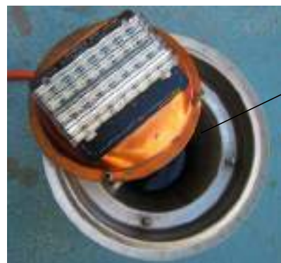
Desenchufe el conector del ensamblaje de la lámpara de LED y remueva el ensamblaje de la carcasa.
